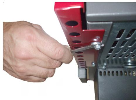
**Fig. 20 - Fijación de los paneles**
