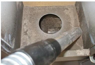
Fig. 37 - Limpieza alojamiento cajón de cenizas
