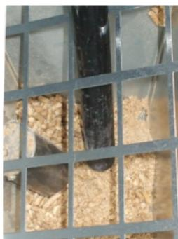
Fig. 40 - Limpieza depósito y coclea
