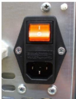
Fig. 23 - Toma de corriente con interruptor general
