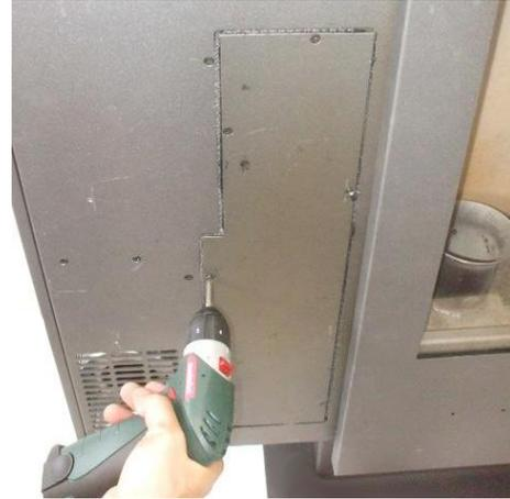
Fig. 42 - Extracción panel de inspección
