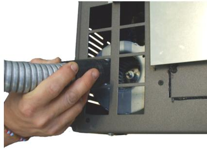
Fig. 49 - Limpieza ventilador ambiente
